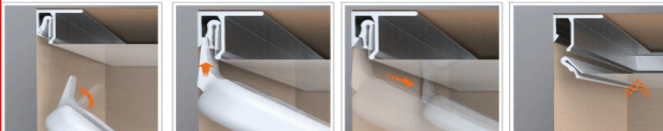
これまでこのような類似のシステムでは、一度固定された膜材は外すことができませんでした。このシステムでは専用の治具を使用することで容易に脱着ができます。
