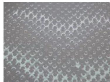
光膜天井で初めて吸音タイプを開発しました。膜に、あるピッチで微細な穴を開け2重レイヤーとし、更に背面空気層を設けることで効果的な吸音光膜となります。
